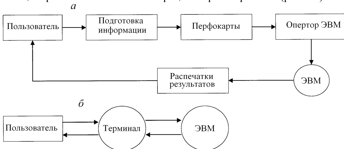
Рис. 3.3. Схема взаимодействия пользователя со средствами САПР: а – пакетный режим; б – диалог с использованием терминала
